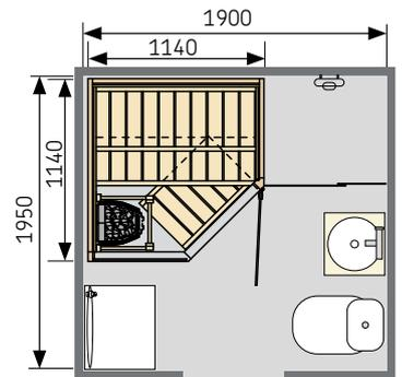
Exemple de positionnement du modèle Sirius SC1111K dans la salle de bain
